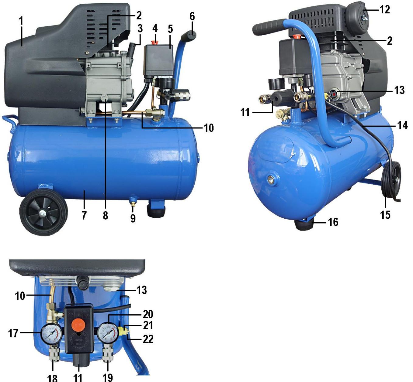
1 – кожух защитный; 2 – компрессорная головка; 3 – сапун; 4 – кнопка выключателя; 5 – реле давления; 6 – ручка; 7 – ресивер; 8 – болт; 9 – клапан слива конденсата; 10 – трубка нагнетательная; 11 – регулятор; 12 – фильтр воздушный; 13 – индикатор уровня масла; 14 – сетевой шнур; 15 – колесо; 16 – опора; 17 – манометр выходной; 18 – штуцер; 19 – штуцер; 20 – манометр ресивера; 21 – предохранительный клапан; 22 – кольцо;
